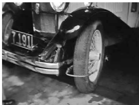
第 31 図 ライレー破損箇所
